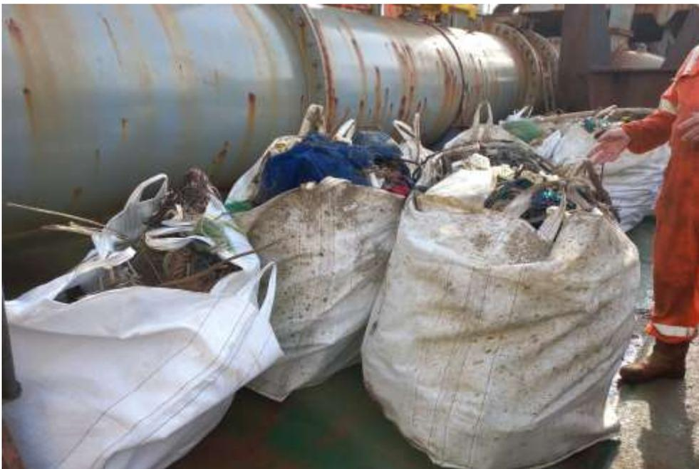
Figura 479: No detalhe os contentores flexíveis utilizados para segregação e acondicionamento dos resíduos retirados das cabeças de dragagem após cada ciclo completo.
