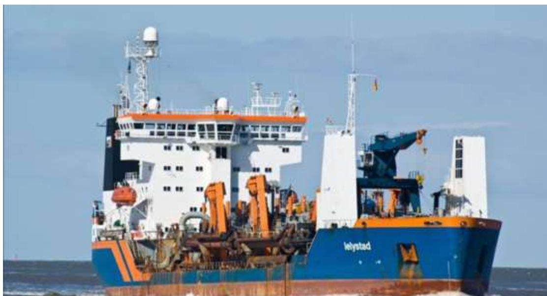
Figura 458: Draga Lelystad, embarcação de dragagem do tipo Hopper, 13.380 kW de potência, profundidade máxima de dragagem de 58 metros e capacidade da cisterna de 10.329 m3.
