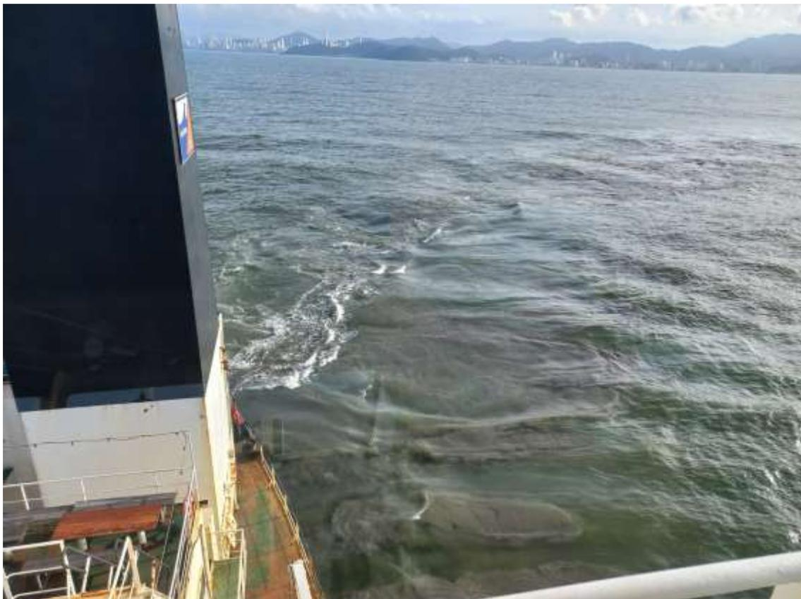
Figura 478: Detalhe da pluma gerada durante o processo de despejo do material contido na cisterna da draga.
