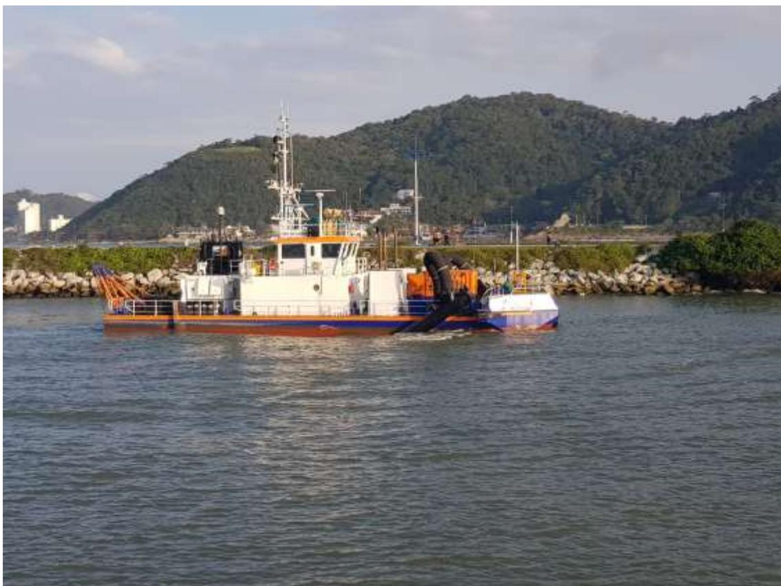
Figura 457: Dragageira Njörd, embarcação de dragagem de injeção de água. Dimensões: 34,7 x 11,67 metros, 1.644 kW de potência e profundidade máxima de dragagem de 21 metros.
