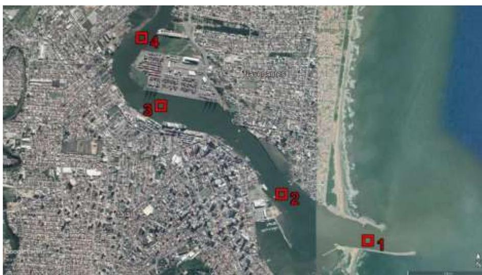
Figura 208: Localização das estações de coleta de dados de velocidades e direções de correntes, salinidade, temperatura e turbidez d'água no estuário do rio Itajaí-Açu. Fonte: Google Earth.
