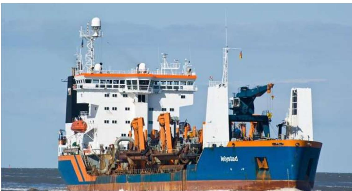
Figura 109: Draga Lelystad, embarcação de dragagem do tipo Hopper, 13.380 kW de potência, profundidade máxima de dragagem de 58 metros e capacidade da cisterna de 10.329 m<sup>3</sup>.
