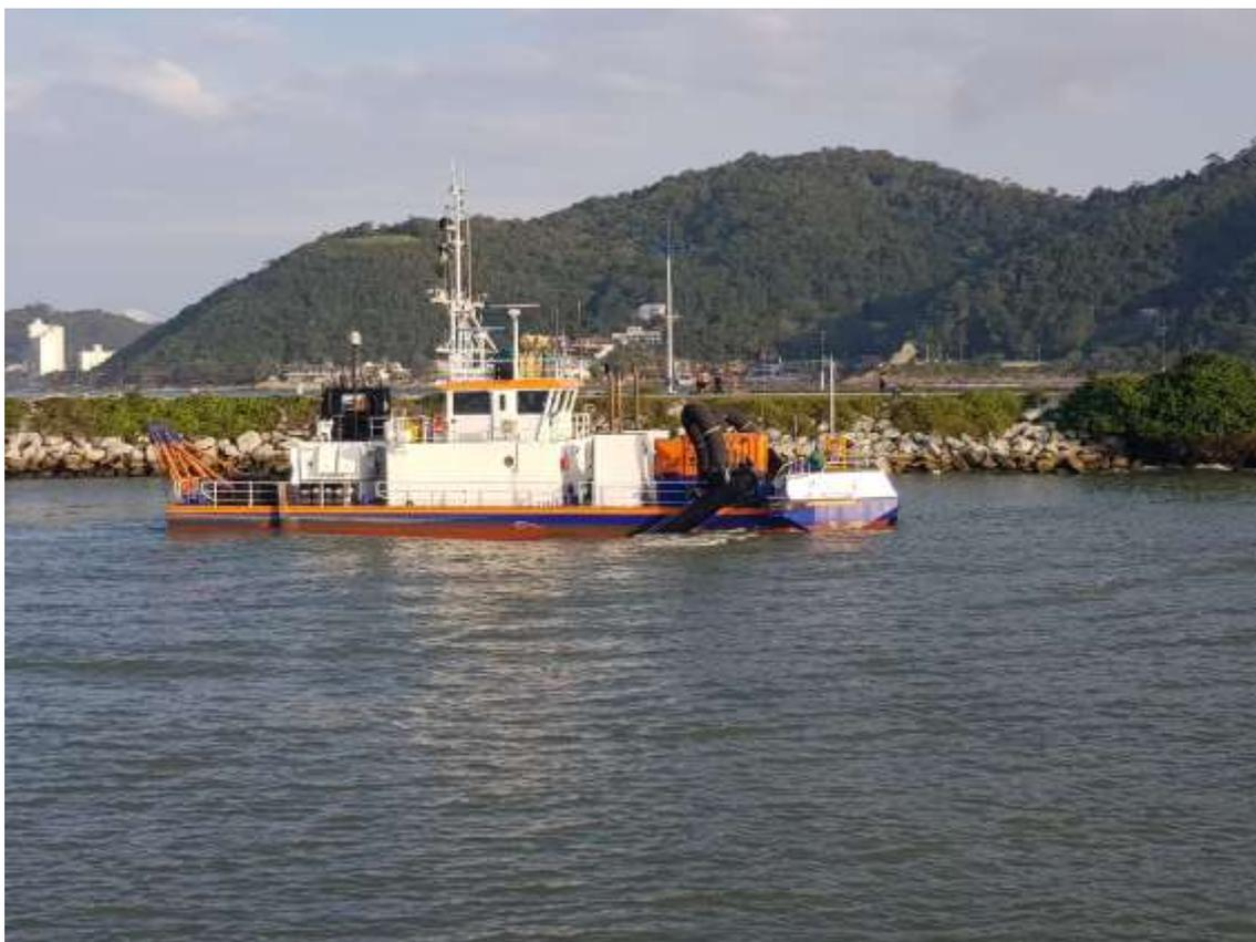
Figura 108: Draga Njörd, embarcação de dragagem de injeção de água. Dimensões: 34,7 x 11,67 metros, 1.644 kW de potência e profundidade máxima de dragagem de 21 metros.
