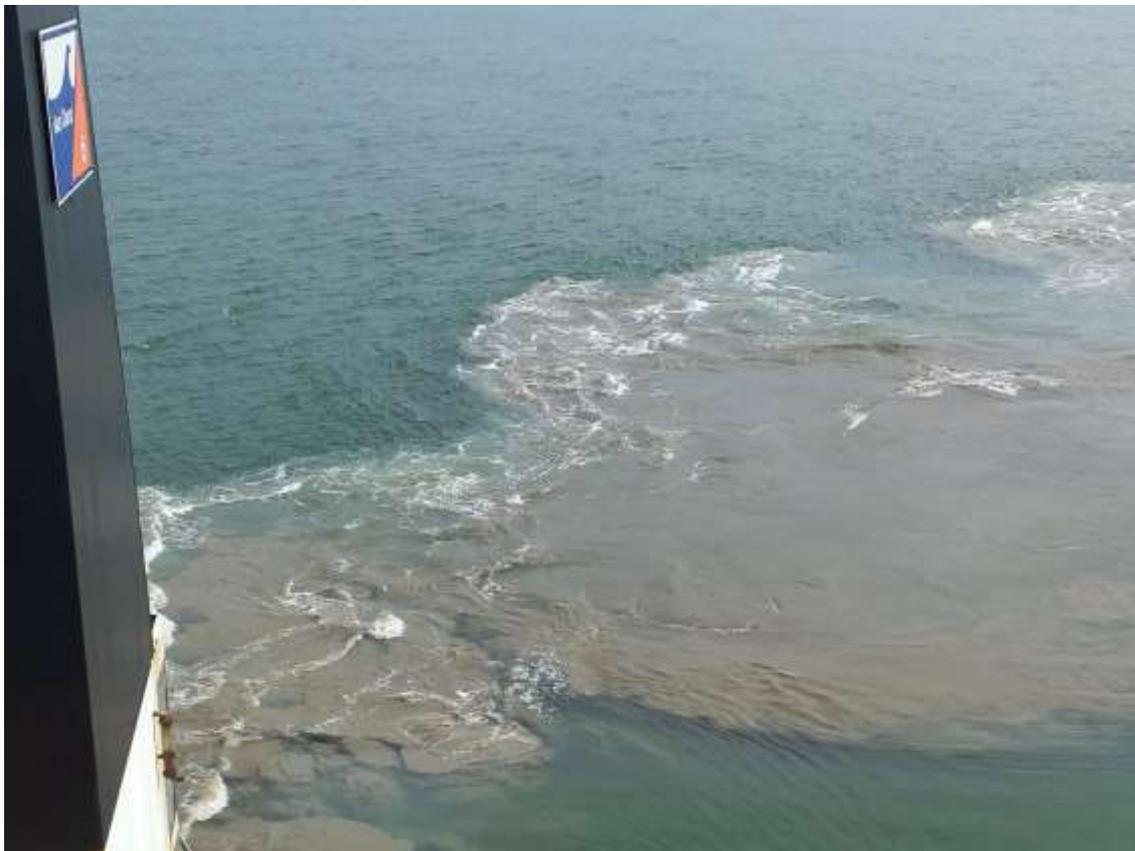
Figura 465: Detalhe da pluma gerada durante o processo de despejo do material contido na cisterna da draga.
