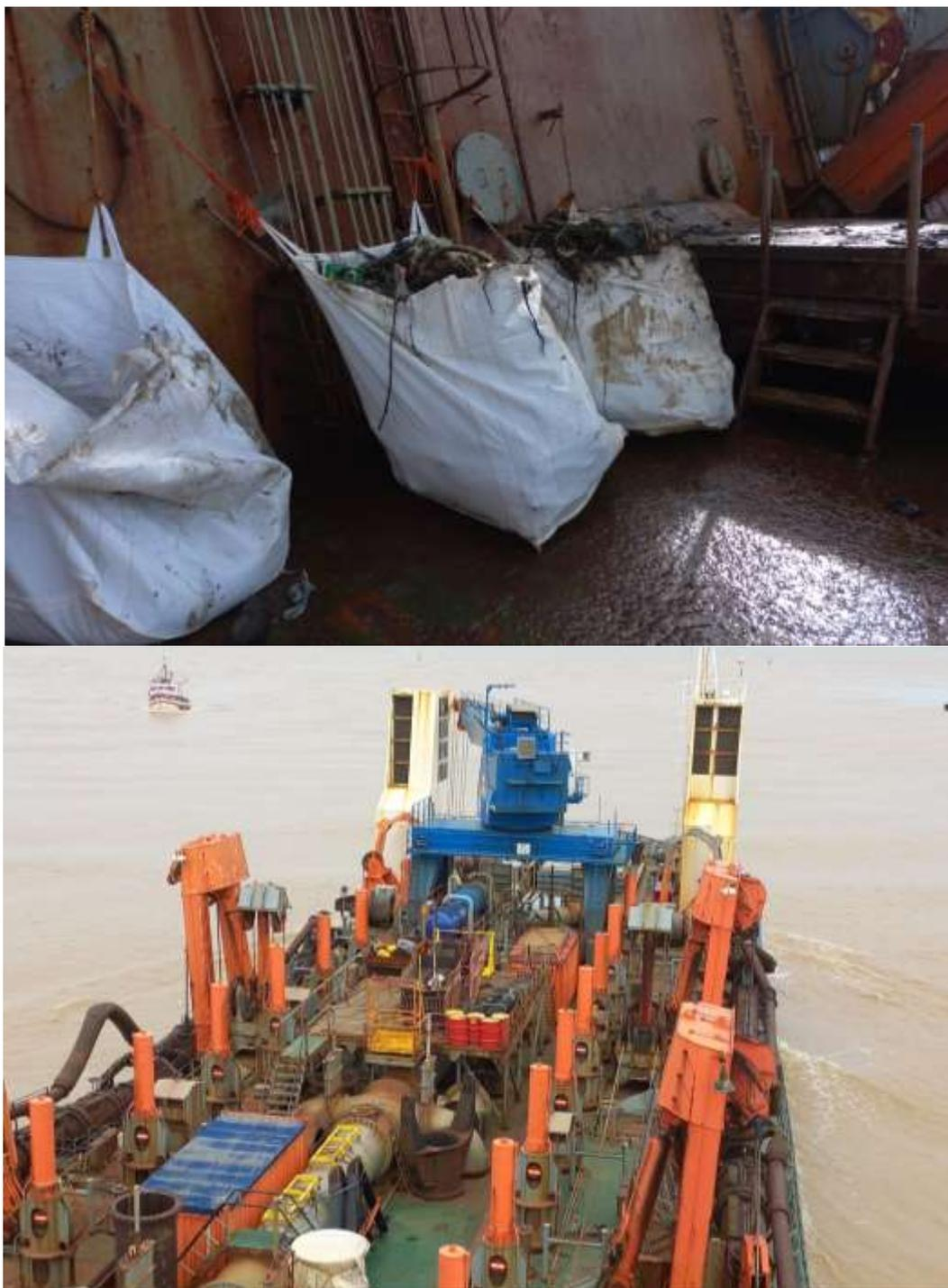
Figura 464: Detalhe da segregação dos resíduos aderidos as cabeças de dragagem direita. Na segunda imagem, percebe-se as caçambas utilizadas para segregação e acondicionamento dos resíduos retirado das cabeças de dragagem após cada ciclo completo.
