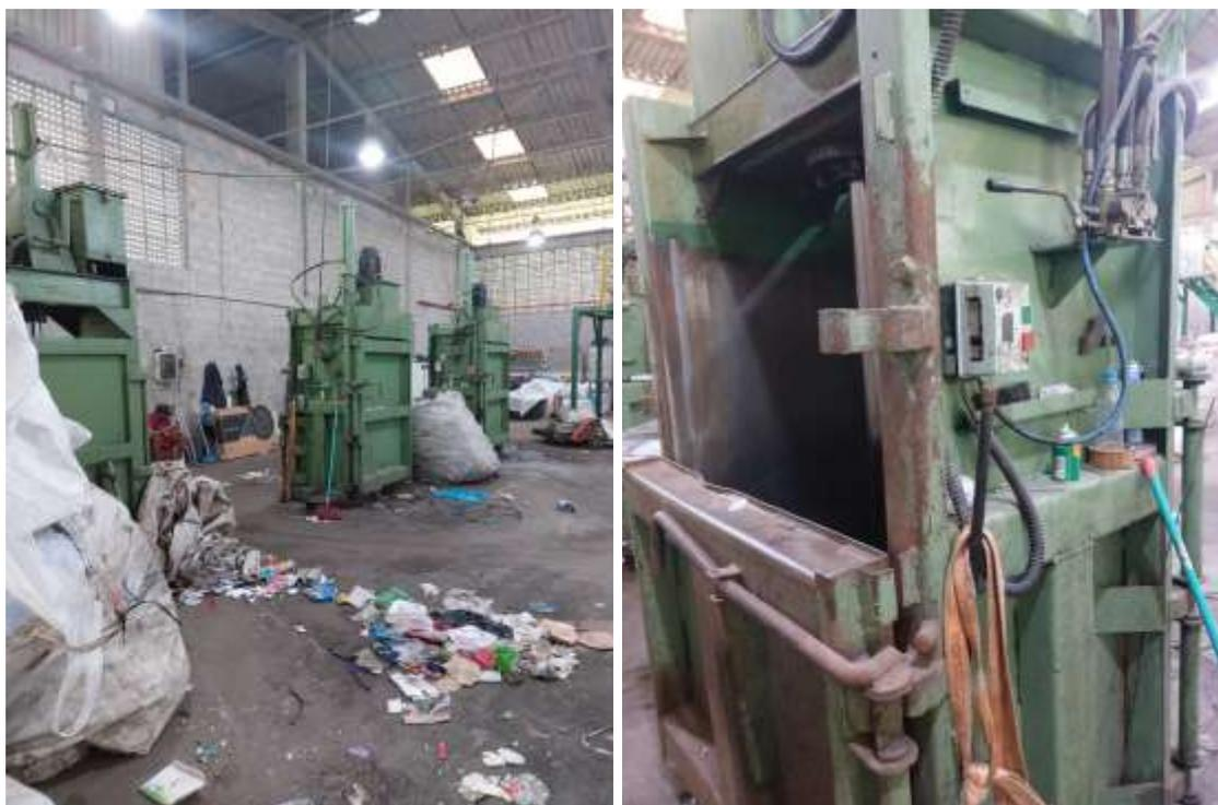
Figura 48: Prensa onde os cooperados realizam a prensagem dos resíduos recicláveis.
