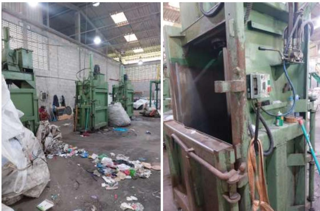
Figura 49: Prensa onde os cooperados realizam a prensagem dos resíduos recicláveis.
